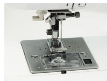
4. Programowalna pozycja zatrzymania igły góra/dół, środek/krawędź oraz jej automatyczne nawlekanie.
